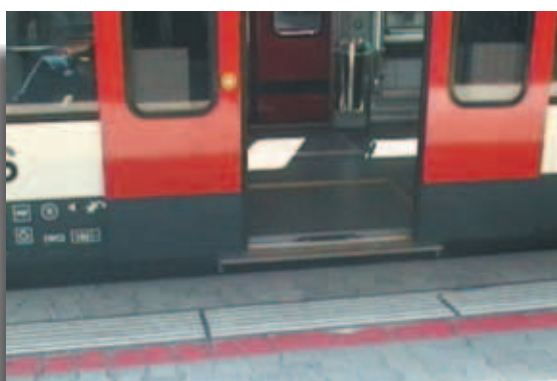
Detalle de señalización de borde de andén, así como de vehículo accesible. Ferrocarriles Suizos.
