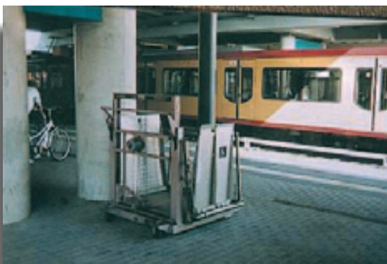
Detalle de plataforma elevadora en andén.
